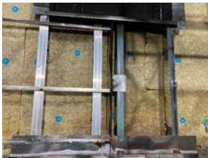
Рисунок 5 – Результаты визуального послойного обследования составляющих образца после проведения испытаний.
